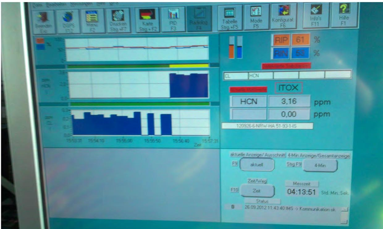
Im Bild sieht man die Bedienoberfläche des ABC-Erkunders mit dem detektierten hochgiftigen Cyanwasserstoff (Blausäure). Als zweiter Schadstoff wurde Chlor gemessen.
